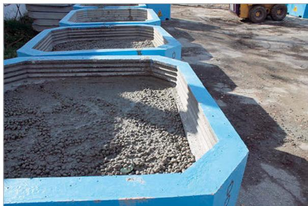
Рис. 1. Упаковки РАО до и после кондиционирования на Балаковской АЭС
