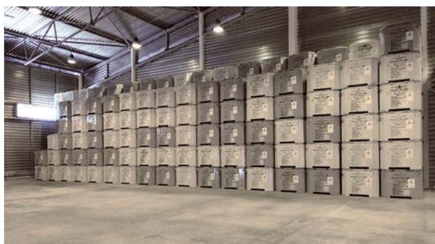
Рис. 6. Размещение на временное хранение упаковок кондиционированных РАО
